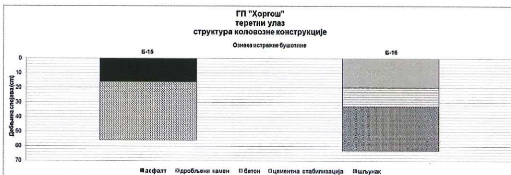
Слика 20 – структура коловозне конструкције возна и претицајна трака, ГП „Хоргош“ – теретни улаз
