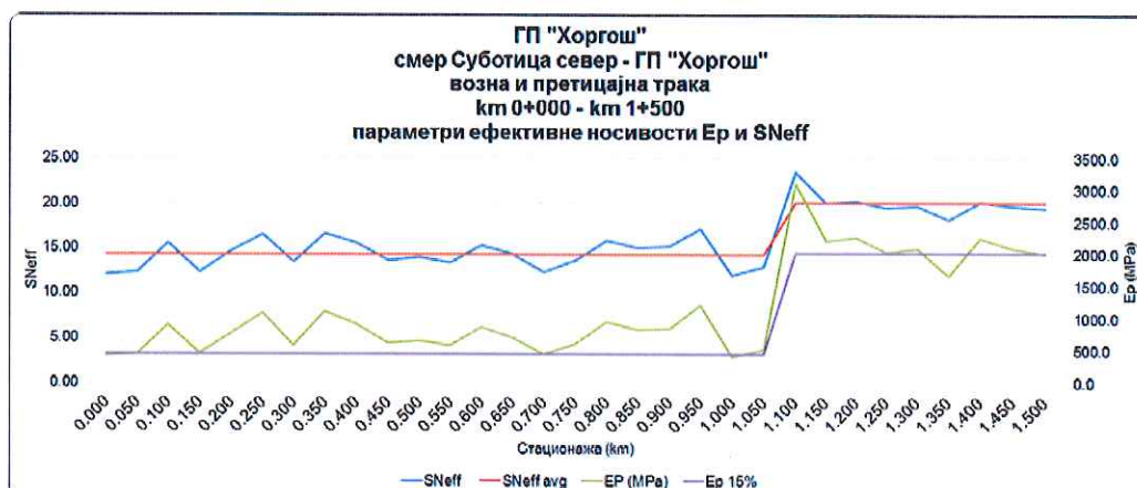
Слика 29 – параметри ефективне носивости, смер Суботица север – ГП „Хоргош“, возна и претицајна трака
