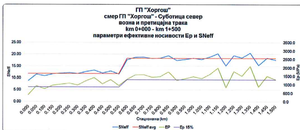
Слика 30 – параметри ефективне носивости, смер ГП „Хоргош“ – Суботица север, возна и претицајна трака
