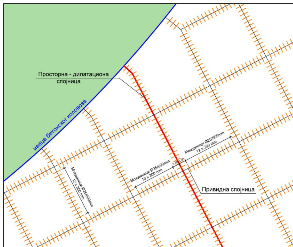
Слика 8.1.3.6 Шематски приказ распореда спојница и можданика у зони проширења у оквиру теретног терминала за смер Србија - Мађарска
