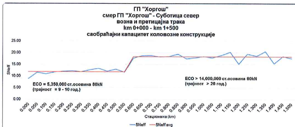
Слика 34 – саобраћајни капацитет коловозне конструкције и трајност, смер ГП „Хоргош“ – Суботица север, возна и претицајна трака
