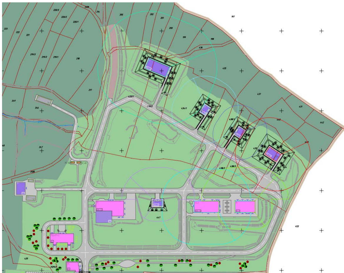
Слика 2: Извод из Идејног решења технологије постројења за производњу композитних ракетних горива и PBX смеша на локацији Јасиковац (26/20-ИДР-07-702) – графички прилог: Ситуациони план са уцртаним безбедоносним удаљењима
