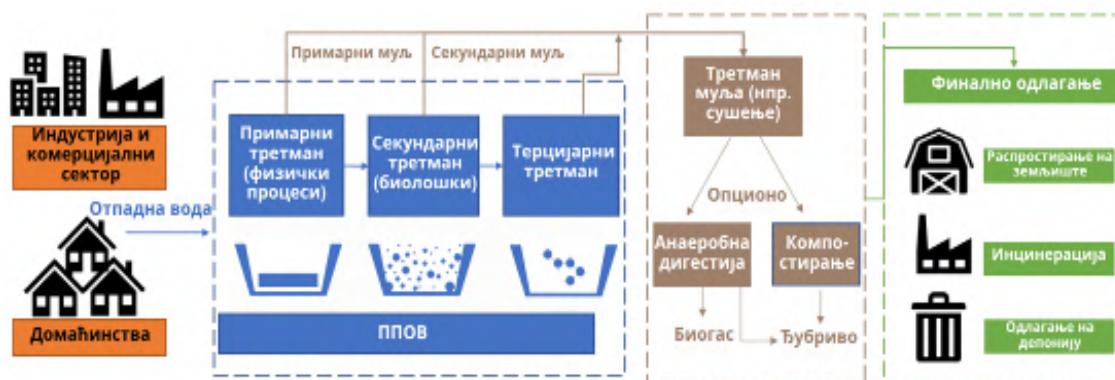
Слика 8.4. Места настанка муља на ППОВ и приказ основних опција финалног одлагања
