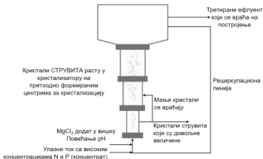
Слика 8.8. Модел реактора коришћеног за преципитацију струвита
