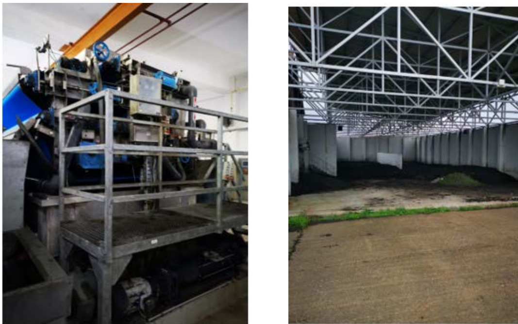
Слика 6. Филтер преса (лево) и складиште обетводњеног муља (десно)
