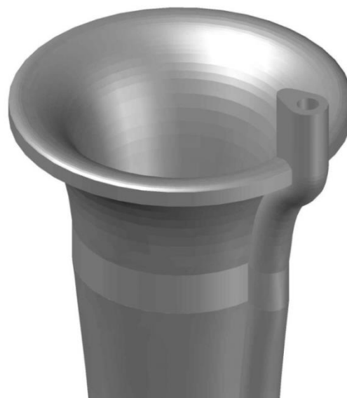
Slika 4.6. Trodimenzionalni prikaz levka dodatnog šahtnog preliava
